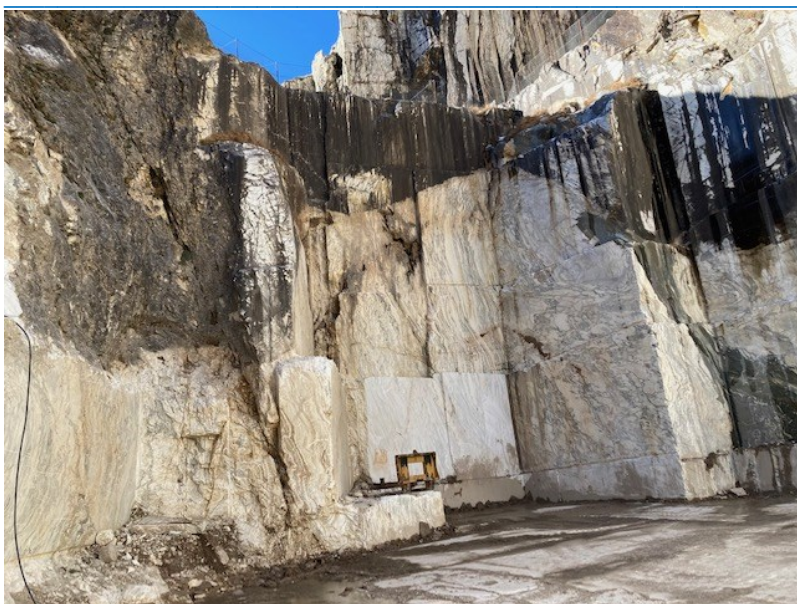
Fig.4 vista della zona di scavo da cui si evidenzia che non vi sono tracce di scorrimento idrico nella parete sud . La parte chiara dei tagli era ricoperta da detrito prima dell'inizio dei lavori
