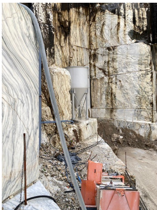
Fig-5 Silo da 15 mc
